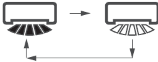
Fig. 37 – Secventa de reglare a jaluzelelor orizontale
