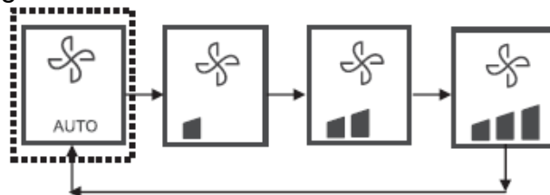
Fig. 28 Secventa celor 3 viteze ale ventilatorului
