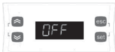
Contatto esterno "Remote On/Off" OPEN CIRCUIT (morsetti 7-8 della TERMINAL BLOCK )
