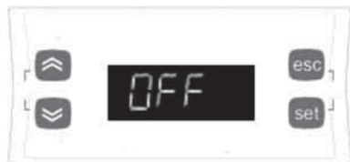
Außenkontakt "Remote On/Off" KREISLAUF OFFEN (Klemmen 7-8 des TERMINAL BLOCKS)
