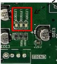
Inverter module (MiSAN-YEE 1 S 6.1-8.1) LED1/ LED2/ LED3
