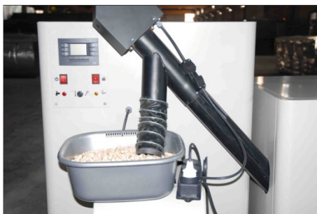
A.4. Snecul de alimentare va incepe sa lucreze continuu. Dupa 6-7 minute, snecul de alimentare pentru peleti va fi plin cu peleti. Asteptati timp de inca 2 minute sa vedeti daca peletii ies din furtunul flexibil pentru a fi siguri ca ati umplut snecul complet. Dupa 2 minute, opriti snecul.
