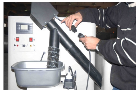
A.3. Conectati din nou sistemul la o sursa de alimentare exterioara (230 V, 50 Hz.) cu ajutorul cordonului dat ca accesoriu la cazan si asezati un vas sub gura furtunului.
