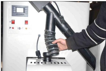
A.2. Scoateti peletii cu ajutorul furtunului flexibil pentru a umple snecul prima oara.
