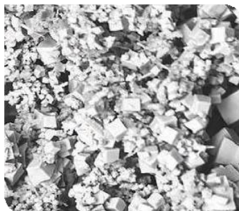
Vedere microscopică (x5000) a stratului protector de hidroxid de cupru \{\text{Cu(OH)}_2\} bine dezvoltat, format pe suprafața interioară a țevii de cupru TALOS®.
