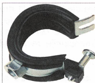
Vedere colier metalic cu garnitura si prindere cu un surub cu filet M8, DN (11÷14) mm
