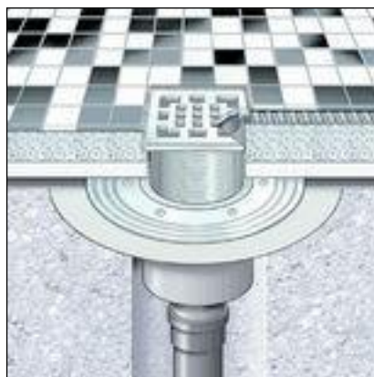
Fig. 3: Schema constructivă a unei etanșări convenționale
