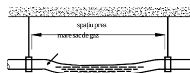
Figura 3-5.4: Efectul unui suport insuficient al conductelor de scurgere
