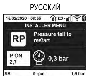
Рисунок 18 Настройка давления нового включения
