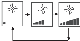
Abb. 28 Die Abfolge von 3 Lüftergeschwindigkeiten des HRV Auto Fan
