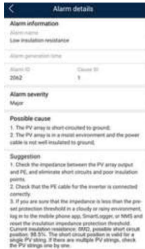
Figura E-1 Detalii alarmă
