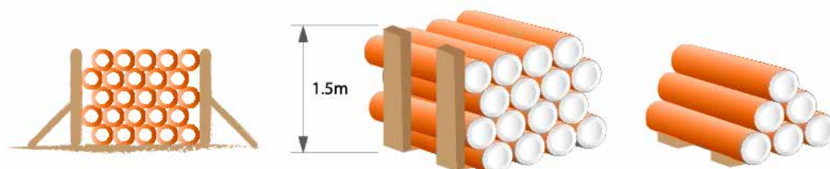
magine nr.11: PVC STRONG țevi așezate corect pe grinzi din lemn
